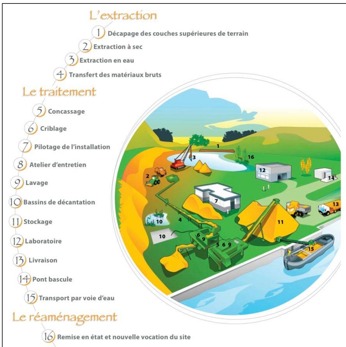
Figure 3 : Représentation schématique de l'activité d'une carrière de roches meubles (d'après audition de l'Unicem, 2016)
