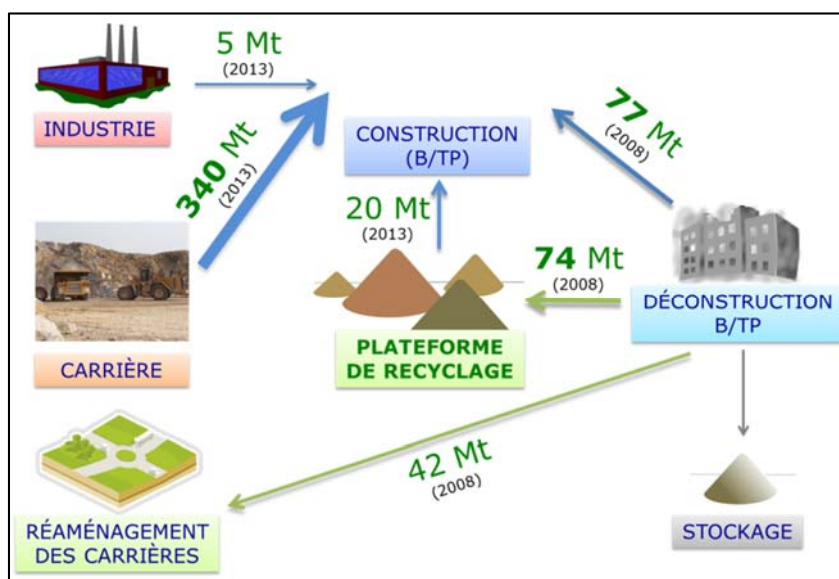
Figure 23 : Schéma de la filière recyclage des déchets de BTP (d'après l'audition de la FNTP et de l'USIRF, 2016)
